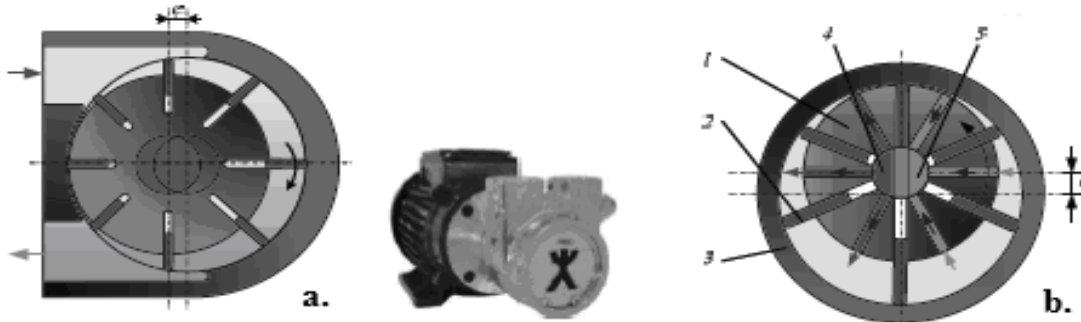
Fig. 6.6. Pompe cu palete glisante: 1 - rotor; 2 - lamele (palete); 3 - arbore motor; 4 - carcasa pompei; 5 - galerie de aspirație; 6 - galerie de refulare.
